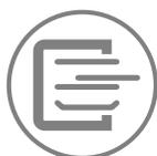
– **Телескопические направляющие** – выдвигающиеся «полозья», которые удерживают противень и позволяют легко вынуть его из духового шкафа. Механизм таких направляющих напоминает телескоп.
